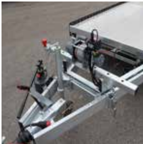
Verschweißter und feuerverzinkter Stahlrahmen
