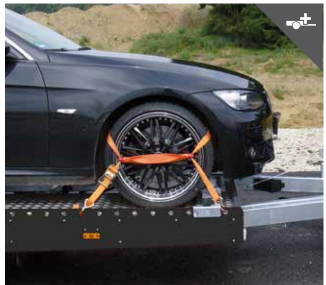
Flexible Verzurrmöglichkeiten der Radsicherungsgurte
