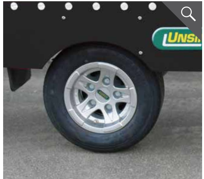
10 Zoll Bereifung für eine niedrige Ladehöhe
